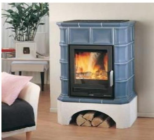
Le stufe in maiolica sono delle stufe che vanno alimentate con molta legna in piccole dimensioni, perché altrimenti genererebbero una specie di falò, cosa che comporterebbe una rapida dilatazione, cosa che causerebbe le rotture nei punti critici e la deformazione dei congegni metallici utilizzati per facilitare l'accensione durante le giornate di bassa pressione.
