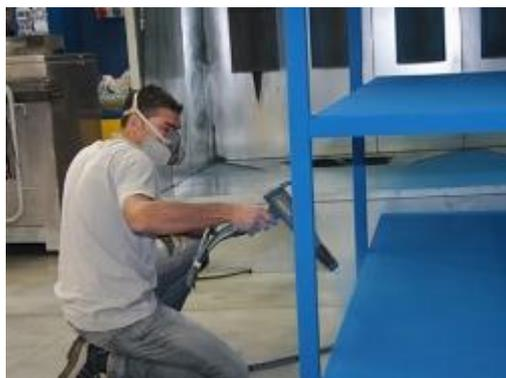
Ma perché scegliere questo tipo di verniciatura? Vari sono i vantaggi comportati dall' utilizzo della pittura in polvere, tuttavia non si può dire che si possano raggiungere sempre: abbiamo già ricordato che se la superficie da trattare non è opportunamente levigata e trattata, la pittura in polvere non risulta adeguata e può rivelarsi, anzi, troppo facilmente degradabile.
