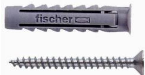
4. Tassello FU: Anche questo, per quanto riguarda i materiali, serve per il calcestruzzo, il mattone pieno o forato, le pietre, il calcestruzzo poroso e il cartongesso, e può tornare utile per fissare lampade, piccole mensole da muro, interruttori elettrici, armadietti da muro, porta asciugamani, cassette postali, guide per tende e canaline per impianti.
